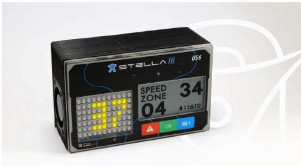
Ao entrar na zona de velocidade controlada, a velocidade máxima autorizada mudará de amarelo intermitente para cor vermelha estável no seu monitor LED.
